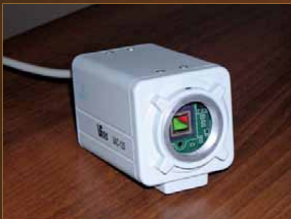
Камера VAC-135 (производство компании "ЭВС", Россия). 1,3 мегапикселя (1280x1024), 15 кадров в секунду, черно-белая, USB 2.0
